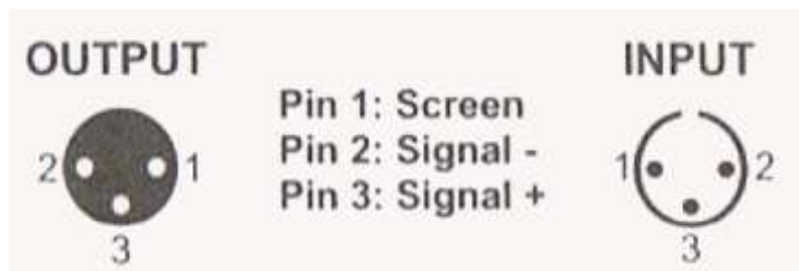
Conector DMX512Três pinos (Canon)
